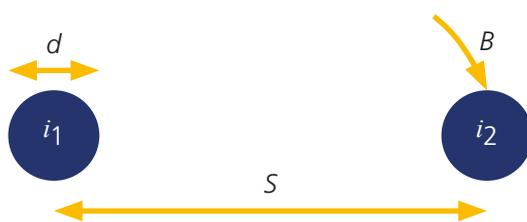
Pour les deux conducteurs parallèles illustrés dans la figure ci-dessus, le champ magnétique créé par le courant  $i_1$  s'exerçant à l'emplacement de l'autre conducteur est de :
