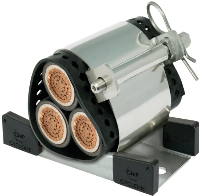
Le collier de câble Cyclone I de CMP Products est un collier métallique composé d'une base en aluminium traité léger et d'une boucle en acier inoxydable. Il a été conçu, fabriqué et testé conformément à la norme internationale relative aux « colliers de câbles pour installations électriques » (IEC 61914:2009). Le collier Cyclone I assure le maintien et la protection des câbles, tout en évitant que le câble ne soit endommagé en fonctionnement normal ou en cas de court-circuit.
