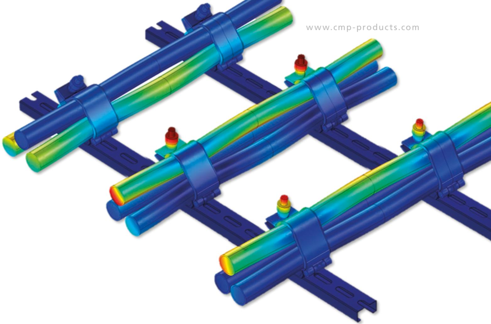
entreprise peut prédire de manière précise les effets électromagnétiques et mécaniques d'un court-circuit sur des câbles électriques et ses capacités de modélisation sont exceptionnelles.
